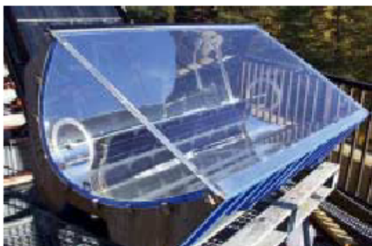
Figur 5: Kort prototyp av solel-solvärmehybrid-MaReCo som utvärderas i Älvkarleby.
