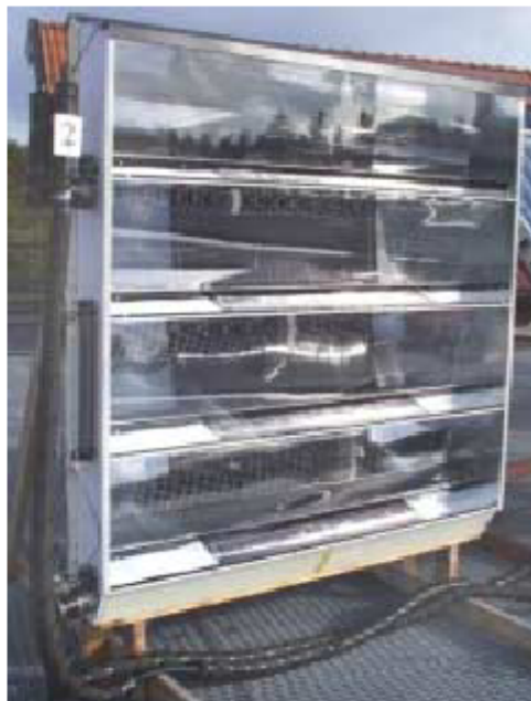
Figur 4: Koncentrerande, vattenkylt solel-solvärmehybridssystem för fasadintegrering. Systemet inkluderar stationära paraboliska aluminiumreflektorer med geometrisk koncentrationsfaktor 3, hybridmoduler och EPS-isolering.
